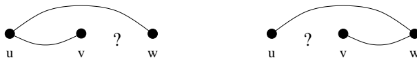
Fig. 6.3. Si G est un graphe de cocomparabilité, alors il existe un ordre LexBFS qui définit une orientation transitive des non-arêtes.
